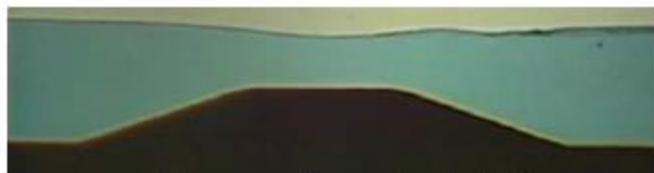
شکل ۱۱-۲ جریان زیر بحرانی بر روی برآمدگی.
