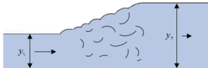
شکل ۳-۱۲ افزایش عمق جریان در پرش هیدرولیکی.
