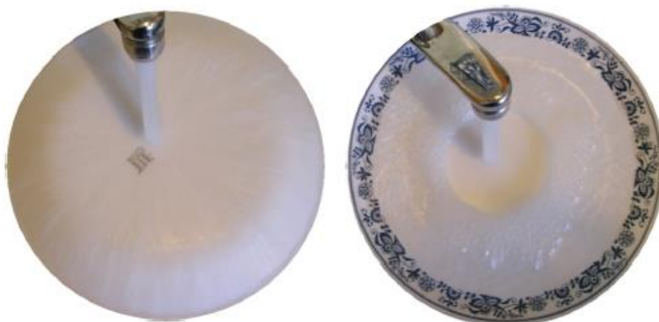
شکل ۵-۳۵ شکل گیری جریان متفاوت بر روی بشقاب و پشت آن از منظر تشکیل یا عدم تشکیل پرش هیدرولیکی [۸].
