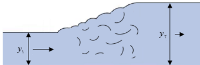
شکل ۳-۱۲ افزایش عمق جریان در پرش هیدرولیکی.
