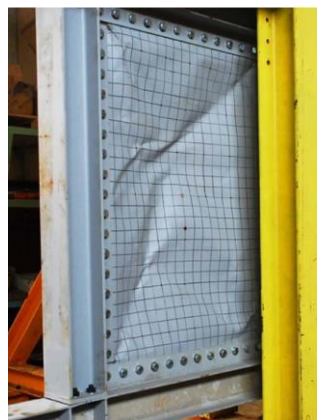
شکل ۷-۱۱: ایجاد ترک در نمونه آزمایشگاهی
