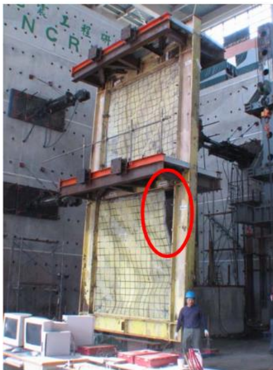
شکل ۹-۷: گسترش ترک در مدل آزمایشگاهی دیوار برشی فولادی دو طبقه [79]
