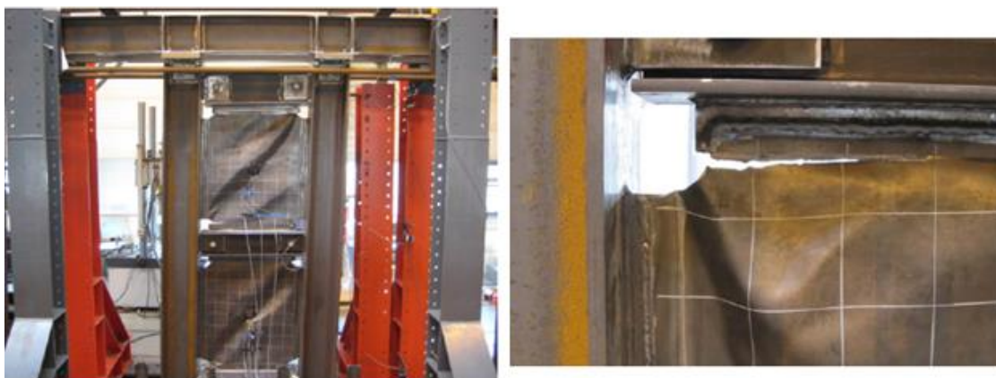
شکل ۷-۱۰: گسترش ترک در ورق فولادی [80]
